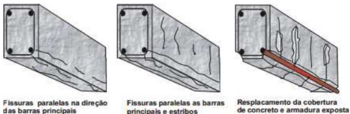
Figura 15 - Fissuras em elementos estruturais decorrente do processo de corrosão. Fonte: Husni (2003).
