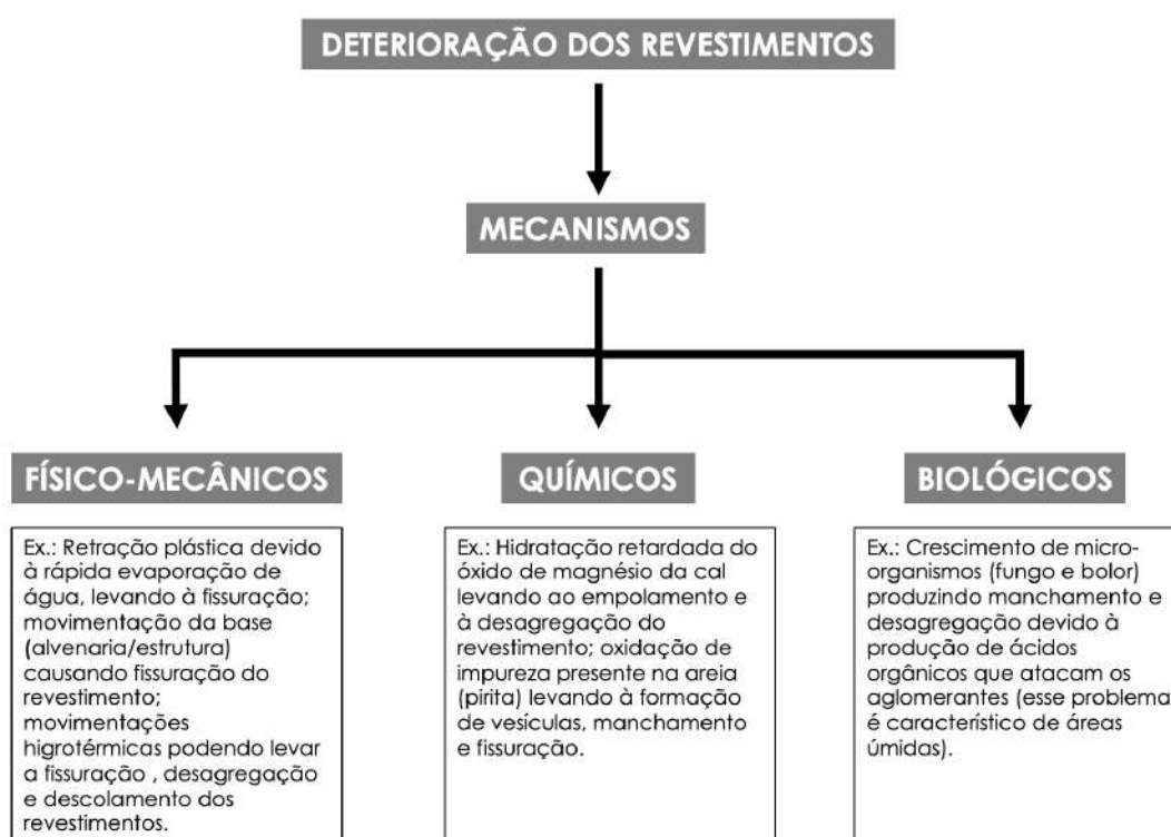
Figura 10 - Mecanismos de deterioração dos revestimentos.
