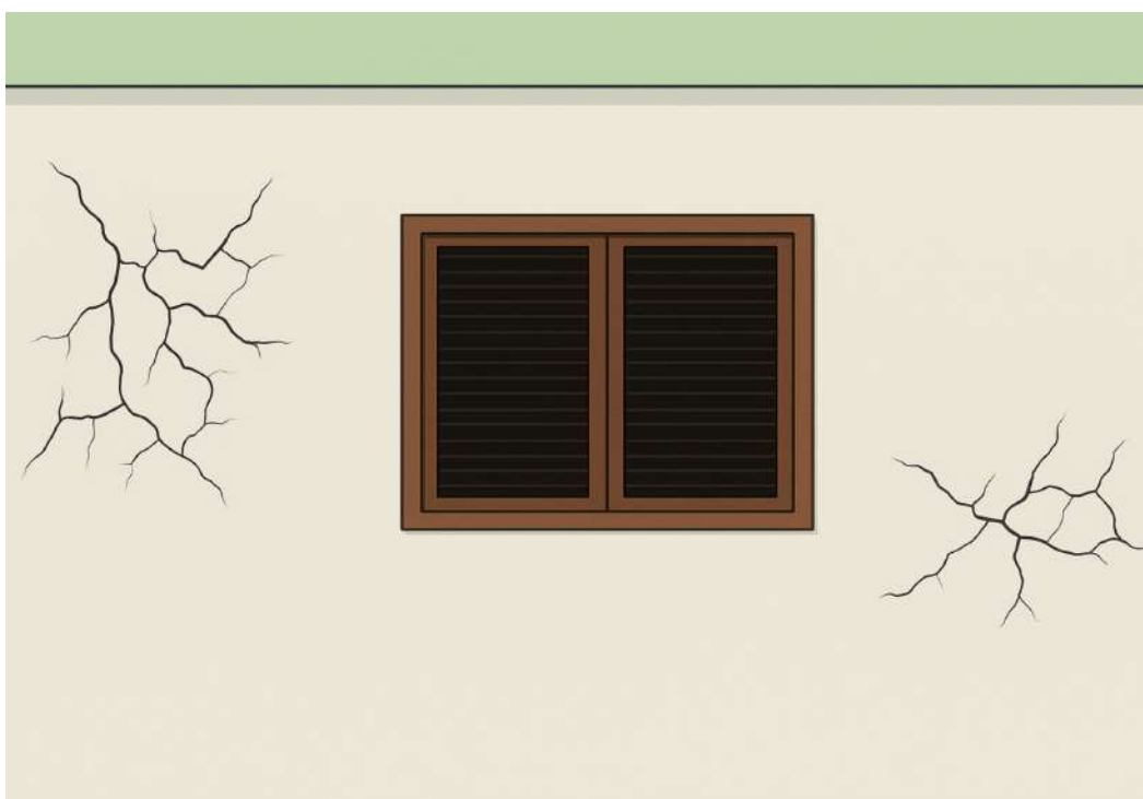
Figura 12 - Fissuras mapeadas em revestimento de fachada. Fonte: Adaptado de Thomaz (2011).
