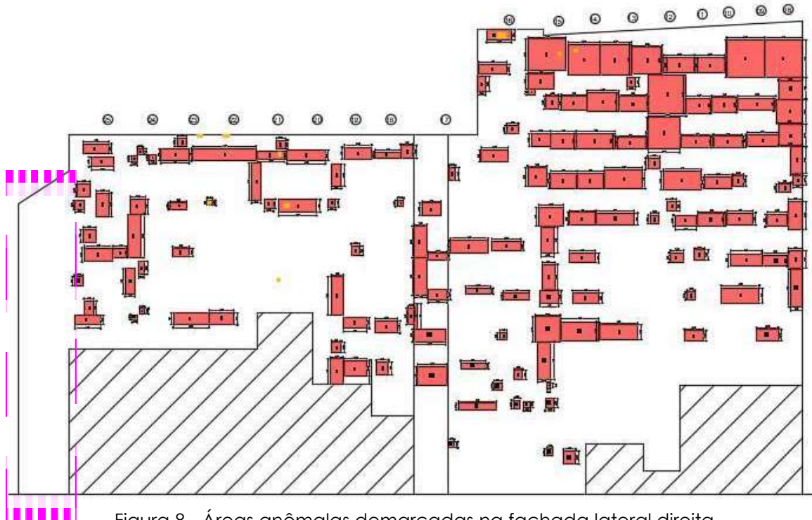
Figura 8 - Áreas anômalas demarcadas na fachada lateral direita.
